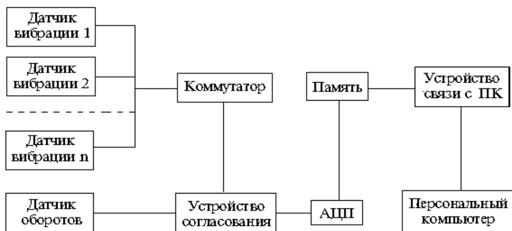
Рис.5.6. Структура входного устройства. АЦП - аналого - цифровой преобразователь
