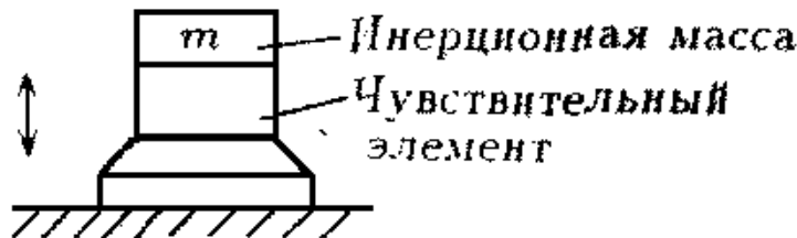
Рис.3.1. Простейшая конструкция виброакселерометра
